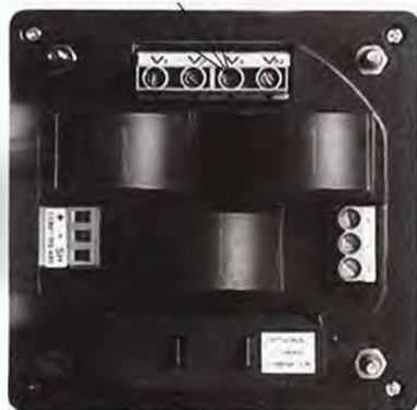
Рисунок 2 - Место пломбирования от несанкционированного доступа (показано стрелкой)
