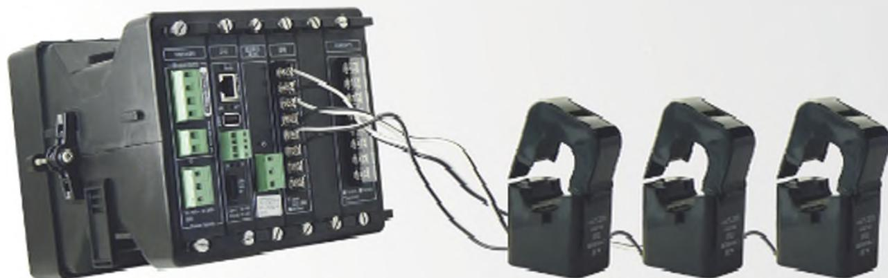
Подключается к релейным ядрам 10P и осциллографирует аварийные процессы с токами до  $40 \times I_{\text{ном}}$
